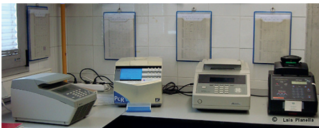
Visió general dels termocicladors del Laboratori d'Ictiologia Genètica de la UdG on s'han dut a terme les diverses reaccions en cadena de la polimerasa per a amplificar el DNA.
